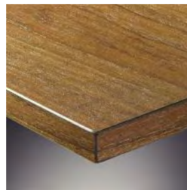
Tischeplatte in Echtholz: Dreischicht-Feinspanplatte, 19 mm stark, mit Echtholz furnier und Massivholzkante.
